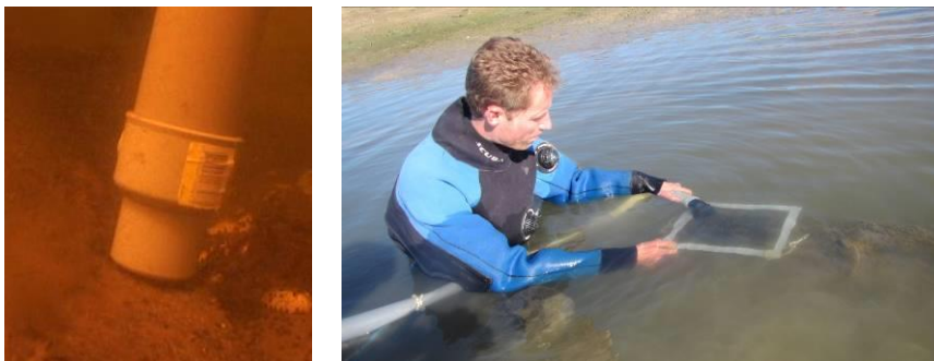
Figuur 3: Macrozoöbenthosstofzuiger aan het werk (links); duiker met kwadrant waarbinnen de macrozoöbenthos geborsteld (gezogen) worden (rechts); foto: Wendy Liefveld, Bureau Waardenburg.
