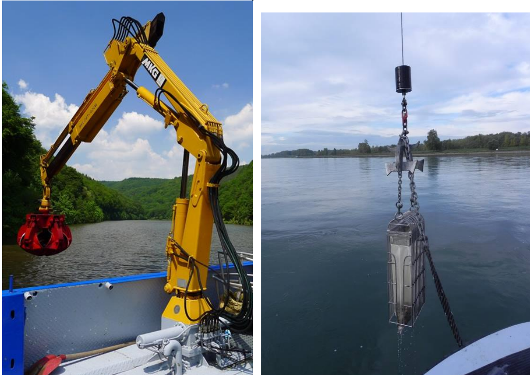
Figuur 2: Bemonstering met het meet- en laboratoriumschip MS Burgund. De grijper neemt monsters van de bodem van grote, bevaarbare wateren (foto links: LfU, J. Fischer); kor (foto rechts: LUBW).
