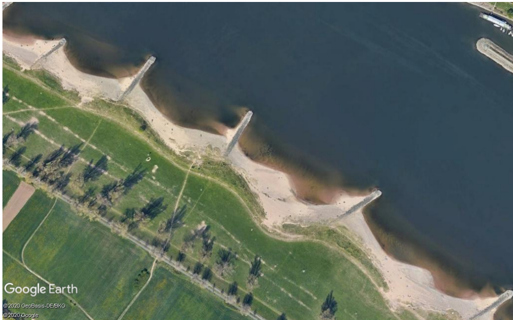
Figure A2.5 : Sur le Rhin inférieur, les enrochements et les champs d'épis se succèdent. Dans les larges zones de fluctuation du débit entre les épis, le risque d'échouement des alevins est grand quand se produit un effet de batillage. Source : GoogleEarth.
