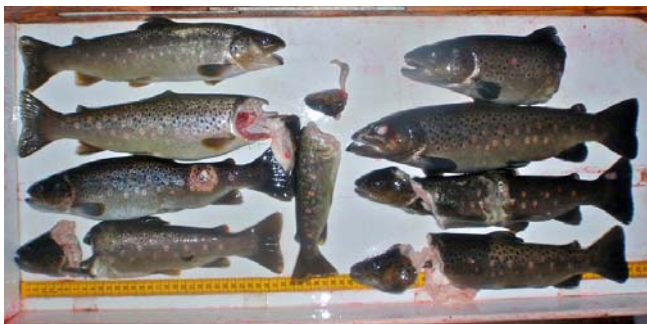
Fig. 3 : illustrations de lésions subies par les salmonidés. Contrôle de fonctionnement de l'installation de dévalaison des poissons sur l'usine de Kostheim au débouché du Main dans le Rhin ; décembre 2011. Source : BSF
