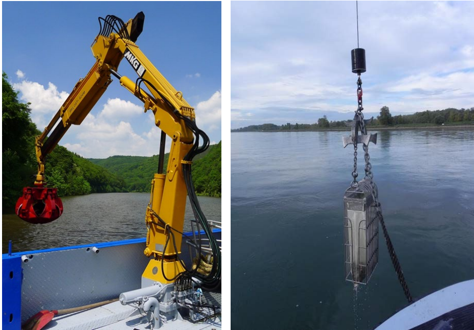
Abbildung 2: Probenahme mit dem Mess- und Laborschiff MS Burgund. Der Greifer birgt Proben vom Grund großer, schiffbarer Gewässer (Foto links: LfU, J. Fischer); Dredge (Foto rechts: LUBW).
