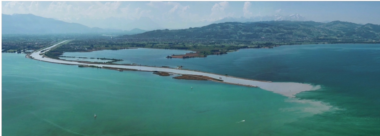
Abbildung A 2.1: Morphologische und kraftwerksbedingte Defizite am Alpenrhein. Oben links: Schwallrückleitung in den Vorderrhein; oben rechts: regulierter Rhein als Grenzfluss zwischen Österreich und Schweiz mit Blocksatz und Steinschlichtungen, daneben der Rheimtaler Binnenkanal. Unten: Mündung des Alpenrheins in den Bodensee mit der sog. Rheinvorstreckung. Fotos: Hydra.
