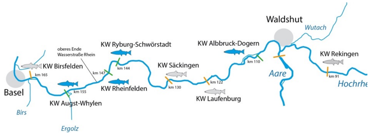
Abbildung B2.4: Staustufen und Situation der Fischwanderhilfen bezüglich Aufstieg im Hochrhein. Oben: Bodensee bis Wutachmündung; unten: KW Rekingen bis Basel. Bezüglich Fischabstieg sind alle Anlagen sanierungspflichtig.
